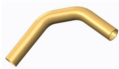
zuerst: Für den Zugkörper wird eine Leitkurve benötigt! Daher gehen wir auf die Registerkarte Modell und wählen den Befehl **Skizze**.
